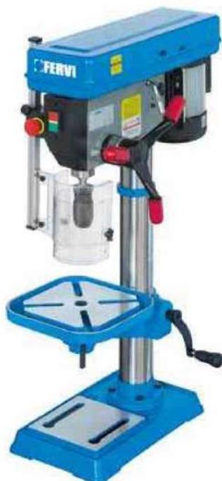
*Fervi - Trapano da banco con trasmissione a cinghia (art. 0750) dotato di 12 velocità di rotazione del mandrino e provvisto di piano girevole e inclinabile. Completano la proposta le punte d'acciaio in lega di cobalto (art. P069) affilate con angolo di 135° e caratterizzate da alta resistenza termica. La serie è composta da 25 pezzi con misure da 1 a 13 mm.*
