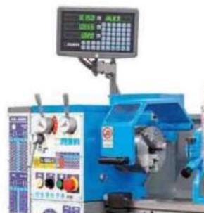
Per una maggiore praticità, i torni vengono forniti già montati e con accessori e specifiche per le diverse lavorazioni eseguibili incluse. Fra gli accessori figurano lunette, contropunte, lampada a LED e sistema di raffreddamento.
